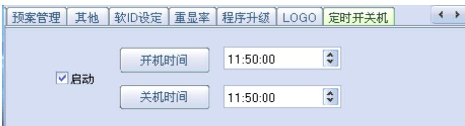
定时开关机，其利用上位机 PC 端软件产生计时器，按照指定时间来发送开关机命令给大屏拼接盒子，从而实现整机的定时开关。
