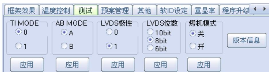
测试项里面有关于大屏拼接盒子 LVDS 信号输出的一些设定（方便点屏测试）和烤机模式的开关，烤机模式必须在无信号的情况下才能开启，功能为：红、绿、蓝、白、黑等颜色闪烁，不需要可以关闭。
