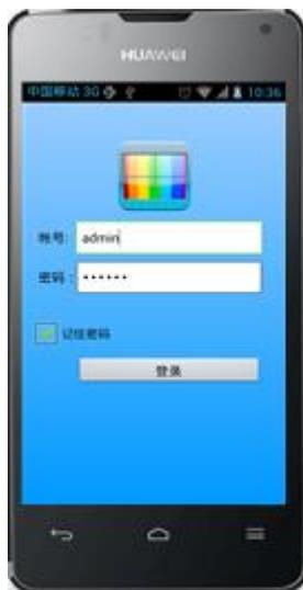
然后输入设备的 IP 和端口号通过 wifi 连接设备进行控制（要保证手机连接的 wifi 的网段和设备的网段相同，即在同一个局域网内）。
