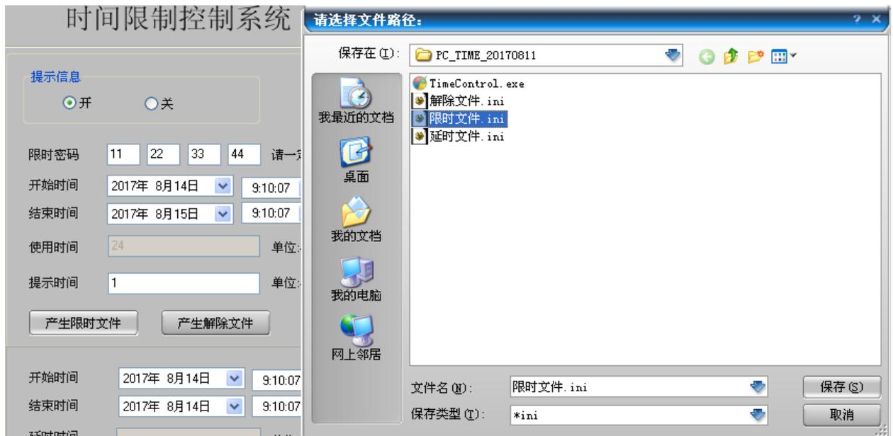
产生的限时文件就可以使用控制软件的注册界面来注册，如下图。先在注册界面上的...点击，找到**限时文件路径**，找到后点保存，然后点击应用就可以开启限时功能，对应屏幕也有菜单提示。
