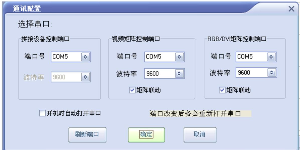
选择正确的通讯端口号，系统才能正常工作。
