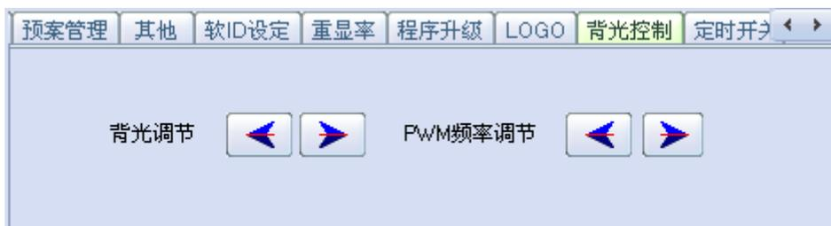
背光控制模块，有背光电压调节和 PWM 输出频率调节。
